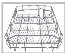
Alguns modelos de máquinas de lavar louça dispõem de sectores inclináveis\* que podem ser usados em posição vertical para posicionar os pratos ou em posição horizontal para posicionar panelas e tigelas.
