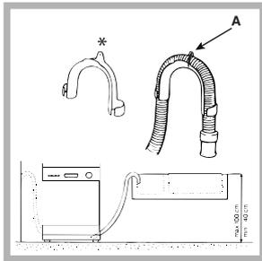
O especial cotovelo\* de matéria plástica facilita o posicionamento ideal: fixe firmemente o cotovelo ao muro para evitar que o tubo se mova e derrame a água fora da descarga
