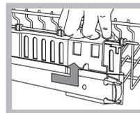
Ist der Korb mit "Dual Space"-Griffen ausgestattet (*siehe Abbildung*), ziehen Sie den Oberkorb bis zum Anschlag heraus, fassen die an den Korbseiten befindlichen Griffe mit den Händen, ziehen diese nach oben bzw. drücken sie nach unten, und lassen Sie den Korb daraufhin herab (hierbei begleiten).
