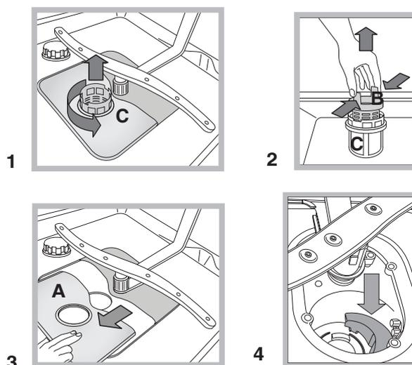
Après avoir nettoyé les filtres, remettre soigneusement le groupe filtrant à sa place, cette opération est fondamentale pour un bon fonctionnement du lave-vaisselle.
