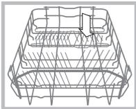
Algunos modelos de lavavajillas poseen sectores reclinables\*, los mismos se pueden utilizar en posición vertical para colocar platos o en posición horizontal para colocar ollas y ensaladeras.
