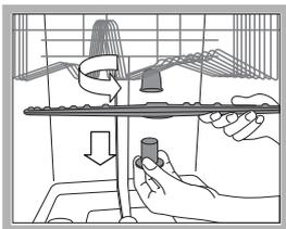
Per smontare l'irroratore superiore, occorre svitare girando in senso antiorario la ghiera di plastica. L'irroratore superiore, va rimontato con la parte con il maggior
