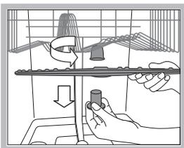
Zur Abnahme des oberen Sprüharms drehen Sie den Kunststoffring gegen den Uhrzeigersinn ab. Der obere Sprüharm ist mit nach oben gerichteten Löchern wieder einzusetzen.
