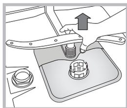
De onderste sproeiarm kan worden verwijderd door hem naar boven te trekken.
