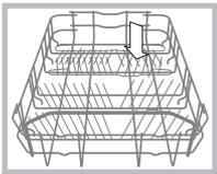
Einige Geschirrspülermodelle verfügen über klappbare Bereiche\*, die in senkrechter Stellung zum Einsortieren von Tellern, oder in waagerechter Stellung zum Einsortieren von Töpfen und Salatschüsseln verwendet werden
