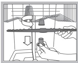
Pour démonter le bras supérieur, il faut dévisser la bague de fixation en plastique (tourner dans le sens inverse des aiguilles d'une montre). Il faut remonter le bras gicleur
