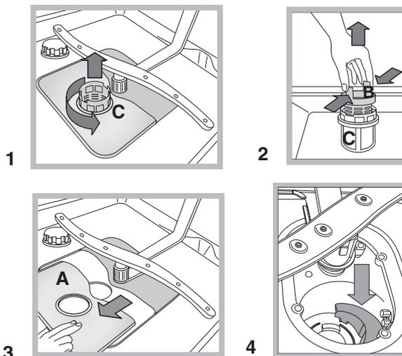
Na het reinigen van de filters dient u de filtergroep weer op zijn plaats te zetten. Dit is fundamenteel voor een goede werking van de afwasautomaat.
