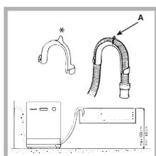
Un coude\* plastique spécial facilite une installation optimale : fixer solidement le coude au mur pour éviter que le tuyau se déplace et déverse l'eau hors du conduit. La portion de tuyau repérée par la lettre A doit se trouver à une distance du sol comprise entre 40 et 100 cm
