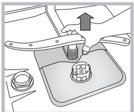
Der untere Sprüharm wird nach oben abgezogen.
