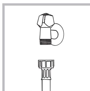
1. Conectați tubul de alimentare, înșurubându-l la un robinet de apă rece cu gura filetată de 3/4 gaz (a se vedea figura). Înainte de conectare, lăsați apa să curgă până când nu a devințe limpede.
