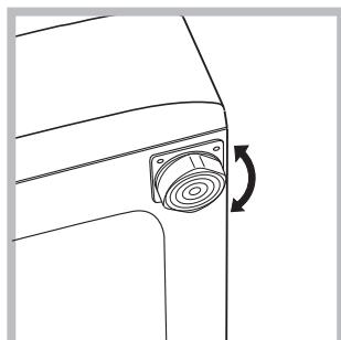
2. Jeśli podłoga nie jest idealnie pozioma, należy skompensować n i e r ó w n o s c i , o d k r ě c a j ą c l u b dokręcając przednie nóżki (patrz rysunek);
