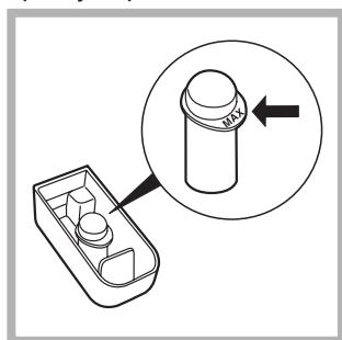
Wstawić dodatkowy pojemniczek 4, na wyposażeniu, do przegródki 1. Przy dozowaniu wybielacza nie przekroczyć poziomu „max” wskazanego na środkowej ośce (patrz rysunek).
