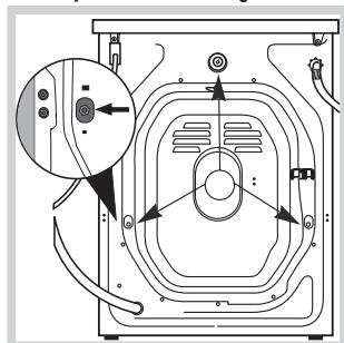
3. Odkręcić 3 śruby zabezpieczające maszynę na czas transportu oraz zdjąć gumowy element z podkładką, znajdujący się w tylnej części pralki (patrz rysunek).
