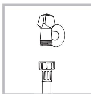
1. Conectar el tubo de tubo enroscándolo a un grifo de agua fría con la boca roscada de 3/4 gas (*ver la figura*). Antes de conectarlo, haga correr el agua hasta que esté limpia.
