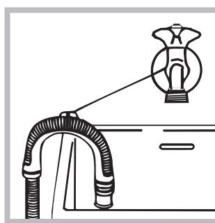
Sprinjiniți-l de marginea căzii sau chiuvelei și racordați șina de ghidare din dotare la robinet (a se vedea figura). Capătul liber al furtunului de golire nu trebuie să rămână cufundat în apă.
