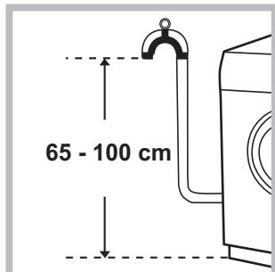
Conectați furtunul de golire - fără a-l îndoia - la canalizare sau la racordul de golire prevăzut pe perete, la o înălțime de 65 - 100 cm de sol;
