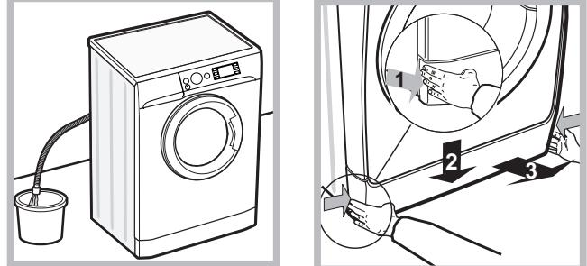
2. βεβαιωθείτε ότι η στάθμη του νερού στο εσωτερικό της μηχανής είναι χαμηλότερη σε σχέση με το άνοιγμα της πόρτας. Σε αντίθετη περίπτωση αφαιρέστε το σε περίσσεια νερό μέσω του σωλήνα αδειάσματος συλλέγοντάς το σε ένα κουβά όπως φαίνεται στην εικόνα.
