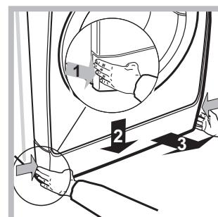
1. Îndepărtați panoul de acoperire de pe latura anterioară a mașinii, apăsând spre centru, apoi împingeți în jos de pe ambele laturi și scoateți-l (a se vedea figura).
