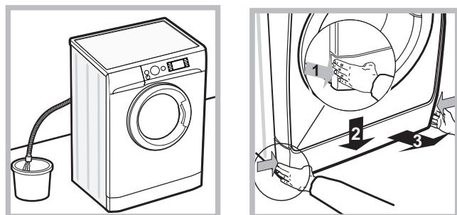
2. verificați ca nivelul de apă din mașină să fie sub marginea ușii; în caz contrar, scoateți apa în exces cu ajutorul furtunului de golire, punând-o într-un vas, după indicațiile din figura.
