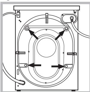
3. Scoateți cele 4 șuruburi de protecție pentru transport și cauciucul cu distanțierul respectiv, situate în partea posterioară (a se vedea figura).
