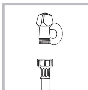
1. Συνδέστε το σωλήνα τροφοδοσίας βιδώνοντάς τον σε ένα κρουνό κρύου νερού με στόμιο σπειρώματος 3/4 gas (βλέπε εικόνα).
