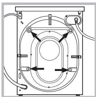
3. Csavarozza ki a gép hátsó részén található, a szál-lításhoz szükséges védőcsavart, és távolítsa el a gumi-bakot (lásd ábra).
