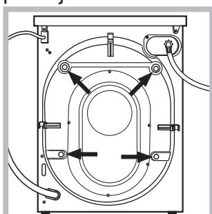
3. Odstraňte šrouby chránící před poškozením během přepravy a gumovou podložku s příslušnou rozpěrkou, které se nacházejí v zadní části (viz obrázek).
