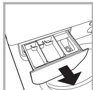
Вийміть касету , піднявши її та витягнувши назовні (див. малюнок). Промийте її під проточною водою; ця процедура має проводитися регулярно.
