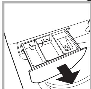
A fiók felemelésével és kifelé húzásával vegye ki a fiókot (lásd ábra). Folyó víz alatt mos-sa ki! Ezt a tisztítást gyakran el kell vé-gezni.
