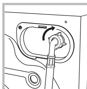
2. Pripojte prítokovú hadicu k práčke, jej zaskrutkováním k príslušnej prípojke na vodu, umiestnejnej vpravo hore (vid' obrázok).
