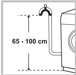
Conectați furtunul de golire - fără a-l îndoiești la canalizare sau la racordul de golire prevăzut pe perete, la o înălțime de 65 - 100 cm de sol;
