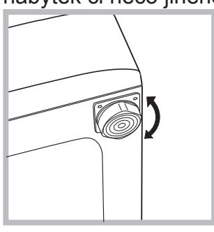
2. V případě, že podlaha není dokonale vodorovná, mohou být případné rozdíly vykompenzovány šroubováním předních nožek (viz obrázek); Úhel sklonu, naměřený na pracovní ploše, nesmí přesáhnout 2°.
