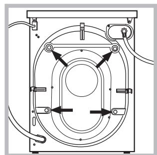
3. Scoateți cele șuruburi de protecție pentru transport și cauciucul cu respectivul distanțier, situate în partea posterioară (a se vedea figura).
