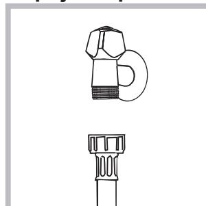
1. Pripojte prívodnú hadicu jej zaskrutkováním ku kohútiku so studenou vodou s hrndlom so závitom 3/4" (vid' obrázok). Pred pripojením hadice nechajte vodu odtieť, až kým nebudete círa.
