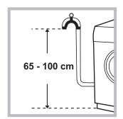
Collegare il tubo di scarico, senza piegarlo, a una conduttura di scarico o a uno scarico a muro posti tra 65 e 100 cm da terra.
