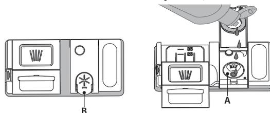
1. Ouvrez le distributeur **B** en appuyant et en tirant sur l'onglet sur le couvercle.
