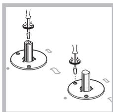
2. Снимите рукоятку и поверните регуляционный винт, расположенный внутри или рядом со стержнем крана, вплоть до получения стабильного малого пламени.
