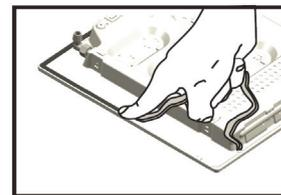
Następnie należy założyć uszczelki dostarczone na wyposażeniu na zewnętrzne krawędzie płyty kuchennej, aby uniemożliwić przedostawanie się powietrza, wilgoci i wody (zob. rysunek). Aby wykonać powyższą czynność prawidłowo, należy upewnić się, że uszczelniane powierzchnie są czyste, suche i nie są zabrudzone smarami/olejami.
