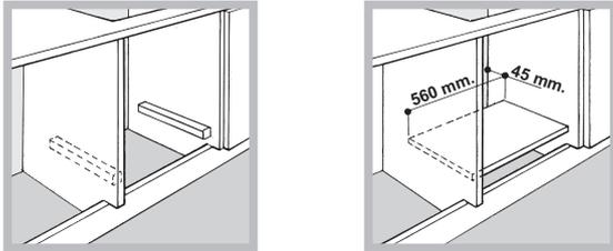
Kui pliit on paigaldatud üle ahju ilma sundventilatsioon jahutussüsteemiga, piisav ventilatsioon peavad olema kapis abil õhu avad, mille kaudu õhk ei liigu (vt joonis).
