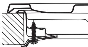
Nostiprināšanas pozīcija galda virsmām ar H=40mm
