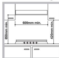
By płyta grzewcza mogła być zainstalowana pod szafką wiszącą, ta ostatnia powinna znajdować się w odległości minimalnej od blatu wynoszącej 700 mm.
