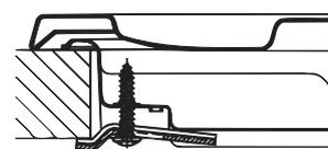
Nostiprināšanas pozīcija galda virsmām ar H=30mm
