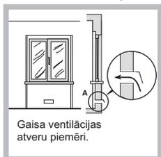
Gaisa cirkulācijas sistēmā gaisu var ievadīt tieši no ārpusē, izmantojot cauruli ar vismaz 100 cm<sup>2</sup> iekšējo diametru; atvere nedrīkst būt bloķēta.
