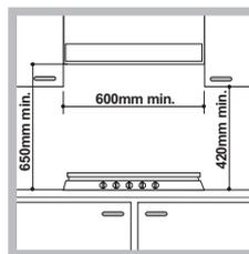
Ja plīts virsma ir uzstādīta zem sienas skapja, tam ir jāatrodas vismaz 700 mm augstumā virs plīts virsmas.
