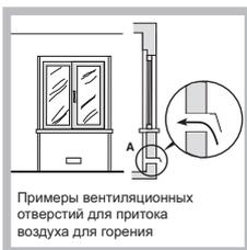
Приток воздуха может обеспечиваться непосредственно снаружи здания через воздуховод полезным сечением не менее 100 см<sup>2</sup> и диаметром, исключающим возможность случайного засорения.
