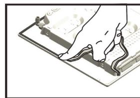
Õhu, niiskuse ja vee tõkestamiseks paigaldage kõik seadme komplekti kuuluvad tihendid piki pliidiplaadi välisservi (vt joonis). Nõuetekohase paigaldamise tagamiseks veenduge, et pinnad on puhtad, kuivad ja ei ole saastunud määrdeaine või -õliga.
