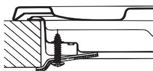
Монтаж крюка для опорных брусьев H=40mm
