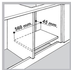
Если варочная панель устанавливается сверху встроенного духового шкафа, не оснащенного принудительной охлаждающей вентиляцией, для надлежащей вентиляции внутри кухонного элемента необходимо проделать вентиляционные отверстия для циркуляции воздуха (см чертежи).
