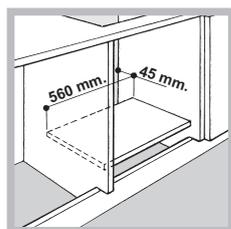
W przypadku instalacji na piekarniku nie wyposażonym w obieg chłodzący należy zapewnić swobodny przepływ powietrza w celu właściwej wentylacji (patrz ilustracje).
