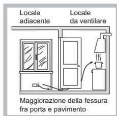
Albo też, w sposób pośredni, z przyległych pomieszczeń wyposażonych w przewód wentylacyjny jak opisany powyżej, a nie będący częścią wspólną dla całej nieruchomości ani nie mający połączeń z pomieszczeniami sypialni lub w których występuje zagrożenie pożarem.
