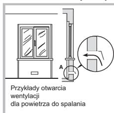
System może polegać na bezpośrednim poborze powietrza z zewnątrz budynku przy pomocy kanału o przekroju użytecznym przynajmniej 100 cm<sup>2</sup> i zabezpieczonego przed przypadkowym zaślepieniem.
