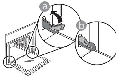
Einen leichten Druck ausüben, um zu überprüfen, dass sich die Haken in der korrekten Position befinden.
