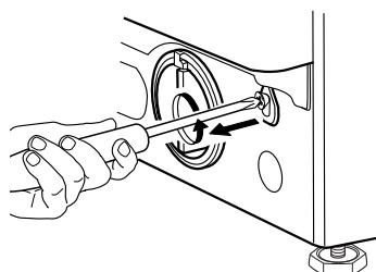
**4.** Zatim ponovno postavite traku tako da odvijačem čvrsto zavijete vijak.
