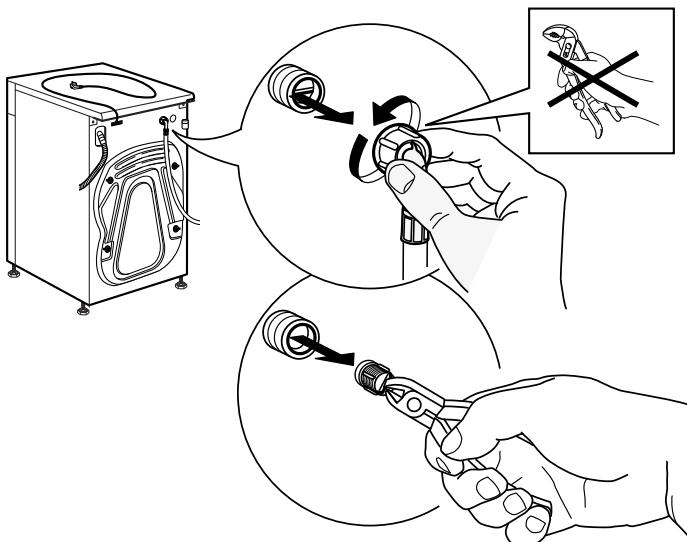
**4.** Ponovno umetnute mrežasti filter. Ponovno spojite dovodno crijevo na slavinu i perilicu. Ne upotrebljavajte alat za spajanje dovodnog crijeva. Otvorite slavinu za vodu i ponovno provjerite jesu li svi spojevi čvrsti.
