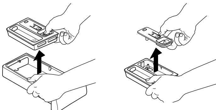
**3.** Sve dijelove očistite tekućom vodom uklanjajući ostatke deterdženta ili omekšivača.
