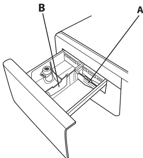
Nel caso di utilizzo di detersivo liquido per il lavaggio, si consiglia di utilizzare la paretina **A** per un corretto dosaggio (la paretina è in dotazione e si trova all'interno del sacchetto con le Istruzioni).
