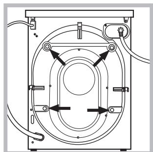
3. Отстранете 4-те защитни винта за предпазване при превоза и гумираната опаковка със съответния раздалечител, намиращи се в задната част (вижте фигурата).
