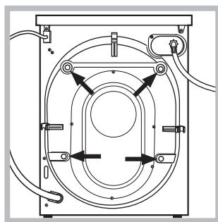
3. Видаліть 4 запобіжні гвинти для транспортування та гумову прокладку з відповідною розпірною деталлю, які знаходяться позаду (див. малюнок).
