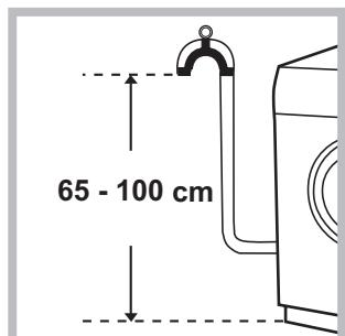
Collegare il tubo di scarico, senza piegarlo, a una conduttrice di scarico o a uno scarico a muro posti tra 65 e 100 cm da terra;
