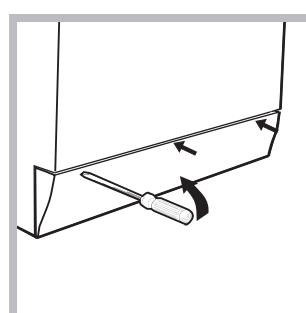
1. rimuovere il pannello di copertura sul lato anteriore della macchina con l'aiuto di un giravite (vedi figura);
