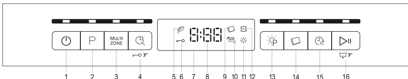
1. Dugme za uključivanje-isključivanje/ponovno podešavanje sa svetlosnim indikatorom
