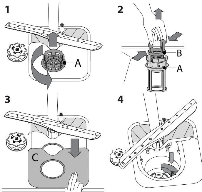
Nakon čišćenja filtera, ponovo postavite sklop filtera i pravilno ih pričvrstite na mesto; ovo je neophodno za efikasan rad mašine za pranje sudova.
