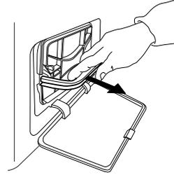
Öffnen Sie die Bodenklappe. Halten Sie den Griff und ziehen Sie den Bodenfilter heraus.
