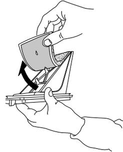
Bringen Sie den Filterschaumstoff am Bodenfilter an. Reinigen Sie die Filterkammer des Trockners vorsichtig mit einem feuchten Tuch oder mit einem Staubsauger. Bodenfilter wieder einsetzen. Klappen Sie den Filtergriff nach unten und schließen Sie die Bodenklappe.
