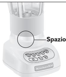
La caraffa non è fissata correttamente al collare di blocco, impedendo ai denti di ingranare. Rimuovere la caraffa dalla base e inserirla a fondo nel collare. Premere e ruotare la caraffa in senso orario nel collare di blocco fino a sentire due clic. In questo modo il gruppo della caraffa sarà in grado di attivare gli ingranaggi. Vedere la sezione "Frullatore".
