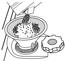
1. Skinite donju košaru i odvijte čep spremnika (u smjeru suprotnom od smjera kazaljke na satu).
