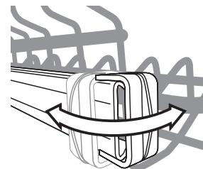
Otvorite dvije kočnice, desnu i lijevu, i izvucite policu.
