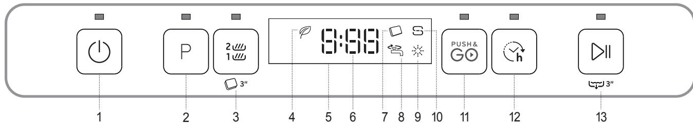
1. Gumb za uklj/isklj/ponovno postavljanje sa svjetлом indikatora
