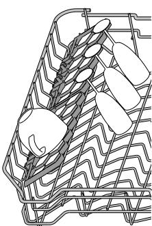
Bočni pomični preklopi mogu se sklopiti ili rasklopiti da bi se poboljšalo slaganje posuđa u košaru.
