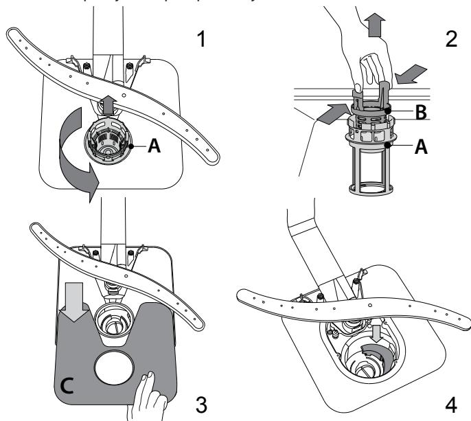
Sihtien puhdistamisen jälkeen aseta sihtiryhmä uudelleen paikalleen ja kiinnitä se oikein; tämä on olellisen tärkeää astianpesukoneen toimintatehon säilyttämiseksi.
