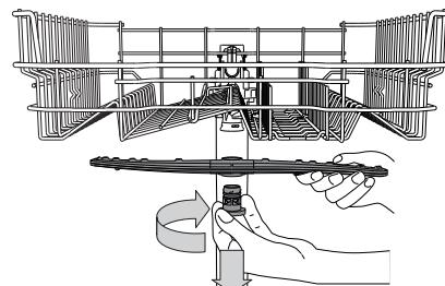
Horní ostřikovací rameno sejměte pootočením plastového upevňovacího kroužku ve směru pohybu hodinových ručiček. Horní rameno lze otočit tak, že jeho strana s větším množstvím otvorů směruje vzhůru.
