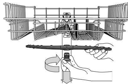
För att ta loss den övre spolarmen, vrid läsringen i plast medurs. Den övre spolarmen ska sättas tillbaka så att sidan med flest hål är vänd uppåt.
