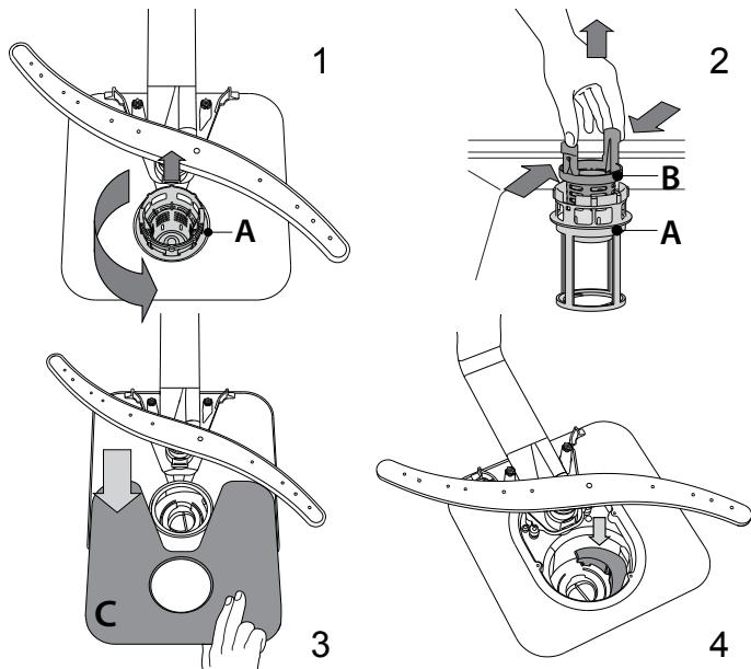
Efter rengöring av filtren, montera tillbaka filterenheten på plats på rätt sätt detta är nödvändigt för att man ska kunna bibehålla diskmaskinens effektivitet.
