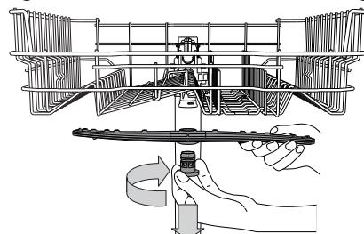
Den øverste spulearm afmonteres ved at dreje plastlåseringen med uret. Den øverste spulearm monteres igen, så siden med flest huller vender opad.
