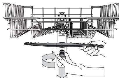
Pour enlever le gicleur supérieur, tournez l'anneau de verrouillage en plastique dans le sens horaire. Le bras d'aspersion supérieur doit être replacé de façon que le côté avec le plus grand nombre de trous est placé vers le haut.
