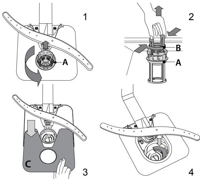
Po oczyszczeniu filtrów założyć z powrotem zespół filtra i zamocować go w prawidłowym położeniu; jest to niezbędne dla utrzymania sprawnego funkcjonowania zmywarki.
