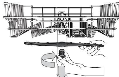
Ylempi suihkuvari poistetaan kiertämällä muovista lukitusrengasta myötäpäivään. Ylempi suihkuvari tulisi vaihtaa niin, että yläpuolelle tulee se puoli, jossa on enemmän reikiä.
