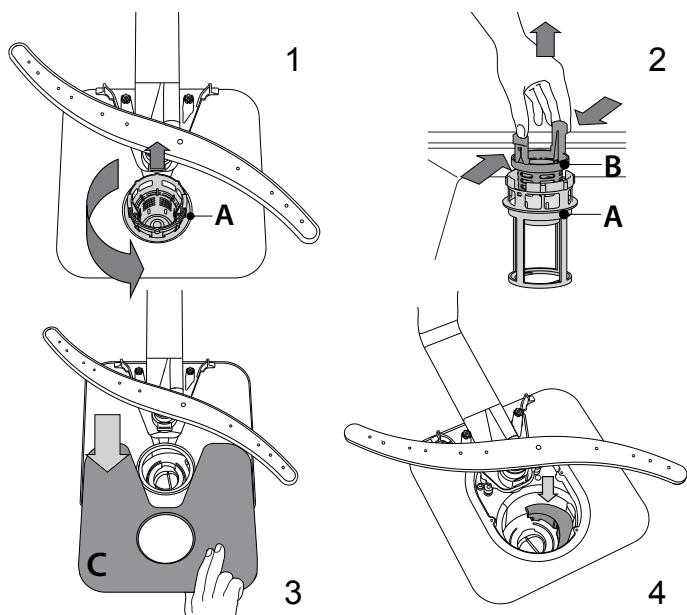
Når filtrene er rengjort, sættes filterenheden på plads og fastgøres i den korrekte position. Dette er afgørende for, at opvaskemaskinen kan fungere effektivt.
