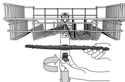
Aby zdjąć górne ramię natyskowe należy przekręcić plastikowy pierścień blokujący w kierunku ruchu wskazówek zegara. Górnego ramienia natyskowego powinno zostać z powrotem założone w taki sposób, aby strona z większą liczbą otworów była skierowana do góry.
