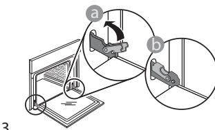
Poskusite zapreti vrata in preverite, da so poravnana z upravljalno ploščo. Če vrata niso poravnana, ponovite zgoraj opisane korake: Če se vrata ne odpirajo in zapirajo pravilno, se lahko poškodujejo.
