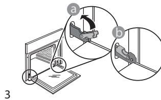
Încercați să închideți ușa și asigurați-vă că se aliniază cu panoul de comandă. În caz contrar, repetați pașii de mai sus: Ușa s-ar putea deteriora dacă nu funcționează corespunzător.
