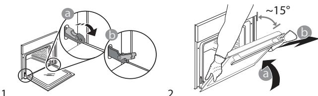
Vrata ponovno namestite tako, da jih pomaknete proti pečici; poravnajte kljuki tečajev z vpetjem in pričvrstite zgornji del v vpetje. Spustite vrata in jih popolnoma odprite. Zaporna vzvoda pritisnite v prvotni položaj (3): Poskrbite, da ju boste popolnoma spustili navzdol. Z nežnim pritiskom preverite, ali sta zaporna vzvoda v pravilnem položaju.
