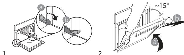
Remontați ușa deplasând-o spre cuptor, aliniind cuplajele balamalelor cu locașurile și fixând partea superioară în locaș. Coborâți ușa și apoi deschideți-o complet. Coborâți dispozitivele de oprire în poziția inițială (3). Asigurați-vă că le-ați coborât complet. Aplicați o presiune ușoară pentru a verifica dacă dispozitivele de oprire se află în poziția corectă.
