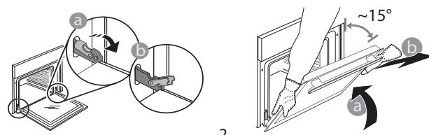
Ponovno postavite vrata pomičući ih prema pećnici, poravnavajući kuke šarki s ležištim i učvršćujući gornji dio na njegovo ležište. Spustite vrata pa ih otvorite do kraja. Šarke spustite u njihov početni položaj (3): Provjerite jeste li ih spustili do kraja. Lagano pritisnite kako biste provjerili jesu li šarke u ispravnom položaju.
