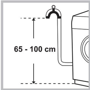
Միացրեք ջրահեռացման խողովակը ջրահեռացման համակարգին գետնից 65-100 սմ բարձրության վրա: Որպես այլընտրանք կախեք ջրահեռացման խողովակի ծայրը լվացարանի, լոգարանի կողքից և ուղղորդի միջոցով (մտնում է մատակարարման կոմպլեկտի մեջ), որը ամրացվում է ծորակին (տես նկ): Խողովակի ազատ ծայրը չպետք է գտնվի ջրի մեջ:
