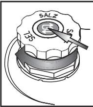
Vissez le bouchon. Éliminez les résidus de sel autour du bouchon. Certains réservoirs à sel ont un indicateur de niveau intégré dans le bouchon (voir la méthode de contrôle ci-dessous).
