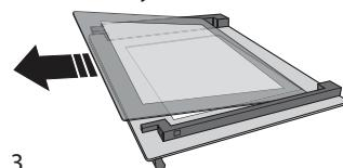
Pour bien replacer la vitre intérieure, assurez-vous que le « R » est visible dans le coin gauche et que la surface claire (pas d'imprimée) est placée vers le haut. En premier, insérez la longue
