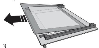
Para volver a colocar los cristales interiores correctamente, asegúrese de que «R» se pueda leer en la esquina izquierda y la superficie lisa (no impresa) esté cara arriba. Primero introduzca
