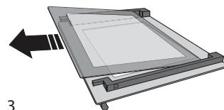
Per riposizionare correttamente il vetro interno, fare attenzione che la "R" sia leggibile nell'angolo destro e che la superficie lucida (non stampata) sia rivolta verso l'alto. Inserire dapprima
