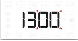
Die beiden Ziffern für die Minuten beginnen zu blinken. Den Knopf drehen, um die Minuten einzustellen und **OK** zur Bestätigung drücken.
