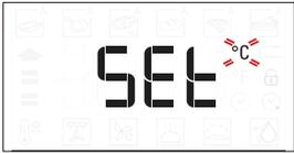
Den Auswahlknopf zur Auswahl der Maßeinheit drehen, anschließend **OK** zur Bestätigung drücken.
