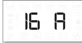
Den Auswahlknopf zur Auswahl des Nennstroms drehen, anschließend **OK** zur Bestätigung drücken.
