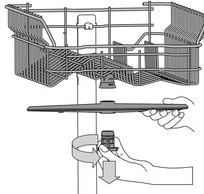
Για να αφαιρέσετε τον επάνω εκτοξευτήρα, περιστρέψτε τον πλαστικό δακτύλιο ασφάλισης αριστερόστροφα. Ο επάνω εκτοξευτήρας πρέπει να επανατοποθετείται με τρόπο ώστε η πλευρά με τις περισσότερες οπές να είναι γυρισμένη προς τα επάνω.
