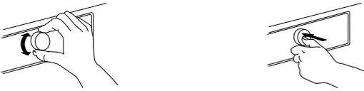
Anschließend können Sie die Wasserhärteeinstellung Ihrer Waschmaschine Ihrer örtlichen Wasserhärte anpassen. Dies wird empfohlen, um die Dosierhilfefunktion zu optimieren. Drehen Sie den Knopf, um zwischen weich / mittel / hart zu wählen und bestätigen Sie durch Drücken des Knopfes.
