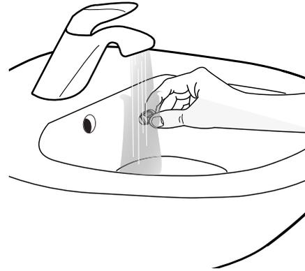
**2.** Reinigen Sie den Feinfilter am Ende des Schlauchs vorsichtig mit einer feinen Bürste.
