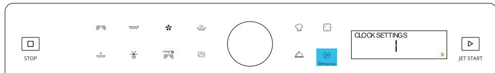
Hodiny lze nastavit stisknutím a podržením tlačítka Stop TT po dobu 3 sekund nebo automaticky při prvním připojení spotřebiče k elektrické sítí (nebo po výpadku napájení), když spotřebič přejde do režimu nastavení hodin.
