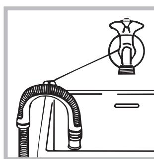
oder hängen Sie diesen in ein Becken oder eine Wanne ein; befestigen Sie den Schlauch in diesem Falle mittels der mitgelieferten Führung an dem Wasserhahn (siehe Abbildung). Das freie Ablau- fschlauchende darf
