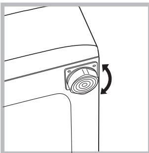
2. Sollte der Boden nicht perfekt eben sein, müssen die Unebenheiten durch An- bzw. Ausdrehen der vorderen Stellfüße ausgeglichen werden (siehe Abbildung), der auf der Arbeitsfläche zu ermittelnde Neigungswinkel darf  $2^\circ$  nicht überschreiten.
