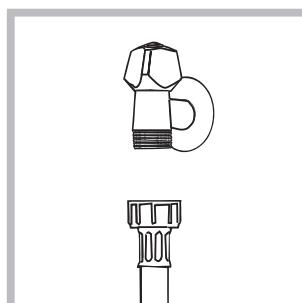
1. Realize a ligação do tubo de alimentação parafusando-o a uma torneira de água fria com bocal de rosca de 3/4 gás(veja a figura). Antes de realizar esta ligação, haja a água escorrer até estar limpida.
