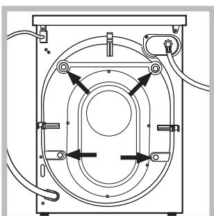
3. Tire os 4 parafusos de protecção para o transporte e a borra-chinha com o respetivo calço, situados na parte traseira (veja a figura).
