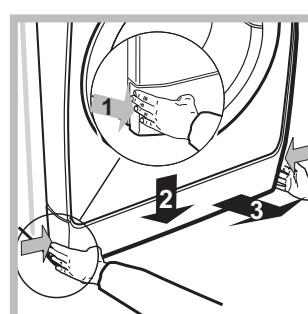
1. Îndepărtați panoul de acoperire de pe latura anteroară a mașinii, apăsând spre centru, apoi împingeți în jos de pe ambele laturi și scoateți-l (a se vedea figura).
