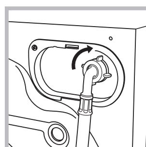
2. Pripojte prítokovú hadicu k práčke, jej zaskrutkováním k príslušnej prípojke na vodu, umiestnej vpravo hore (vid' obrázok).
