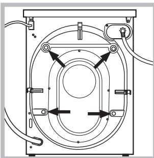
3. Die 4 Transportschutzschrauben ausschrauben und das an der Rückwand befindliche Gummiteil und das entsprechende Abstandsstück abnehmen (siehe Abbildung).
