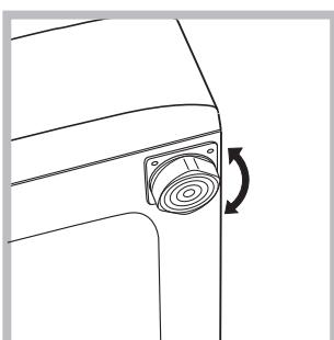
2. Dacă podeaua nu este perfect orizontală, compensați neregularitățile deșurubând sau însurubând piciorușele anterioare (a se vedea figura); unghiul de înclinare, măsurat pe planul de lucru, nu trebuie să depășească 2°.
