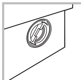
2. Drehen Sie den Deckel gegen den Uhrzeigersinn ab (siehe Abbildung): es ist ganz normal, wenn etwas Wasser austritt.
