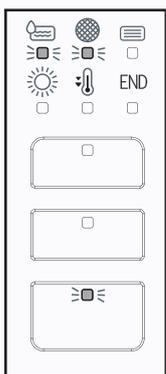
Gleichzeitig blinkende LEDs weisen auf eine Störung hin. Die auf dieser Seite beschriebenen Abläufe ausführen. Den Wäschetrockner abschalten und vom Stromnetz trennen. Sofort die Tür öffnen und die Wäsche herausnehmen, damit die Hitze entweichen kann. Etwa eine Stunde abwarten. Den Trockner wieder an das Stromnetz anschließen, die Wäsche einfüllen und das Programm starten.
