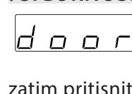
Ta se funkcija automatski uključuje kako bi se sprječilo slučajno uključivanje pećnice. Otvorite i zatvorite vrata pa zatim pritisnite za pokretanje funkcije.
