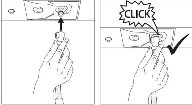
Veillez noter : Il n'y a qu'une façon de raccorder le tuyau, en maintenant le bouton poussoir sur le côté gauche.
