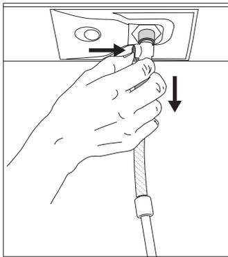
Une fois lancé, le processus s'arrêtera automatiquement quand le réservoir sera rempli. À la fin, l'écran vous demandera de débrancher le tuyau en appuyant sur le bouton sur son côté supérieur gauche et en le tirant légèrement vers le bas.
