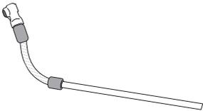
Fixer le tuyau sur la buse pour remplir le réservoir d'eau.
