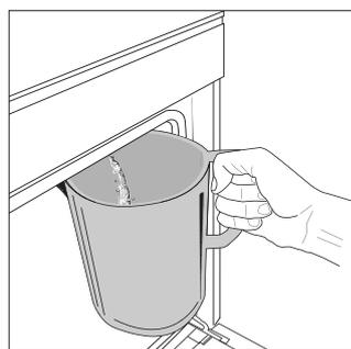
Une fois la fonction « VIDANGE » sélectionnée ou lorsque cela est suggéré sur l'écran, démarrez la fonction et suivez les actions indiquées : Ouvrez la porte et placez un grand pichet (d'une capacité d'au moins 2 litres) sous la buse de vidange située dans le bas du panneau, sur la gauche de la buse d'entrée. Si nécessaire, il est
