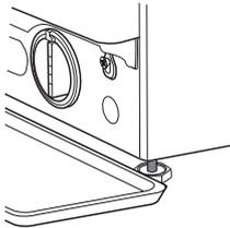
3. Ispustite vodu: Polako okrećite filter u smjeru suprotnom od smjera kazaljke na satu dok sva voda ne isteče. Pustite da voda isteče, a da ne uklonite filter. Kada je spremnik pun zatvorite filter za vodu tako da ga okrenete u smjeru kazaljke na satu. Ispraznite spremnik. Postupak ponavljajte sve dok voda ne isteče.
