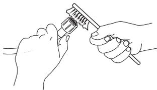
3. Sada rukom odvijte dovodno crijevo za vodu na stražnjem dijelu perilice rublja. Ključem izvucite mrežasti filter iz ventila na stražnjem dijelu perilice rublja i pažljivo ga očistite.
