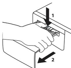
2. Uklonite umetak iz odjeljka za omekšivač.
