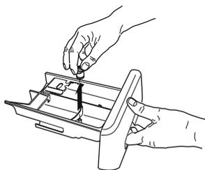
3. Sve dijelove očistite tekućom vodom uklanjajući ostatke deterdženta ili omekšivača.
