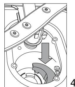
Nakon čišćenja filtera, ponovo postavite sklop filtera i pravilno ih pričvrstite na mesto; ovo je neophodno za efikasan rad mašine za pranje sudova.
