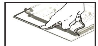
Для крепления варочной панели используйте скобы (A), входящие в комплект поставки. Вставьте скобы в соответствующие отверстия (они обозначены стрелкой) и закрепите их винтами в соответствии с толщиной столешницы (см. рисунки ниже).
