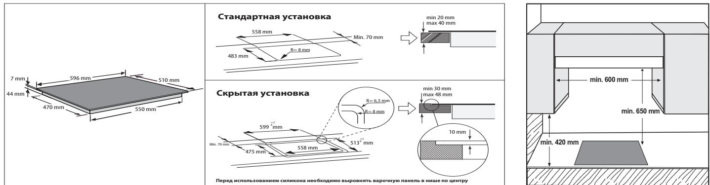
**ПРИМЕЧАНИЕ:** Если расстояние А между настенными шкафчиками составляет от 600 мм до 730 мм, то высота В должна быть не менее 530 мм. Если расстояние "А" между корпусами настенной мебели больше ширины варочной панели, то высота "В" должна быть не менее 400 мм. В случае установки над варочной панелью вытяжки необходимо соблюдать размеры, указанные в руководстве по эксплуатации вытяжки
