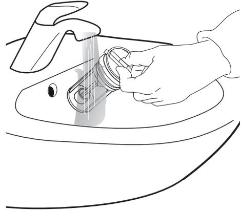
**6.** Insérez le filtre à eau et réinstallez la plinthe : Replacez le filtre à eau en le tournant dans le sens horaire. Assurez-vous de le tourner aussi loin que possible ; la poignée du filtre doit être en position verticale. Pour vérifier l'étanchéité du filtre à eau, vous pouvez verser environ 1 litre d'eau dans le distributeur de détergent. Replacez ensuite la plinthe.
