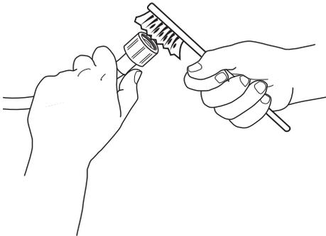
**3.** Dévissez ensuite à la main le tuyau d'alimentation au dos du lave-linge. Sortez le filtre à tamis de la soupape au dos du lave-linge avec des pinces et nettoyez-le soigneusement.
