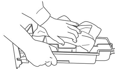
**6.** Seulement si vous avez enlevé les butées de caoutchouc pour vider le contenu du réservoir (étape 3) : Remplacez les butées de caoutchouc. **Assurez-vous qu'elles sont bien insérées** pour éviter que du détergent ne s'échappe accidentellement.
