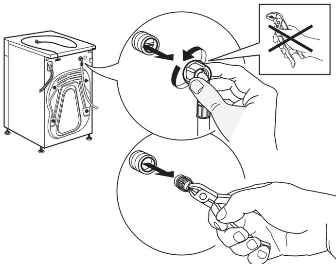
**4.** Replacez le filtre à tamis. Rebranchez le tuyau d'alimentation au robinet d'eau et au lave-linge. N'utilisez pas d'outils pour brancher le tuyau d'alimentation. Ouvrez le robinet d'eau et assurez-vous que tous les raccords sont bien serrés.
