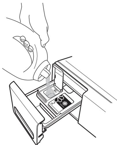
Remplacez le rabat du réservoir et poussez le distributeur de détergent dans le compartiment du distributeur.
