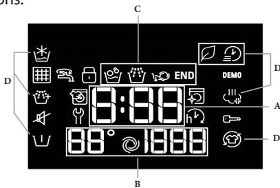
La durée des cycles de lavage disponibles et la durée restante du cycle en cours apparaissent dans la partie A (l'écran affiche la durée maximale du cycle choisi, qui pourra baisser au bout de quelques minutes puisque la durée réelle du programme dépend de la quantité de linge à laver et des paramètres sélectionnés) ; si vous avez sélectionné l'option DELAYED START (DÉPART DIFFÉRÉ), le compte à rebours jusqu'au démarrage du cycle de lavage sélectionné apparaîtra.
