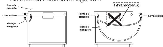
! Si alguna de estas condiciones no puede ser respetada o si la cocina se instala según las condiciones de la clase 2 – subclase 1 (aparato empotrado entre dos muebles), es necesario recurrir al tubo flexible de acero (ver más adelante).
