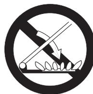
**ATENCIÓN!** La tapa de vidrio se puede romper, si se calienta. Apagar todos los quemadores o, si existen, las placas eléctricas antes de cerrarla.
