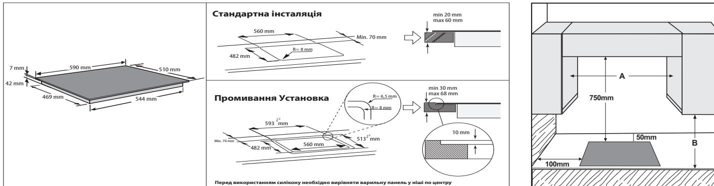
**ПРИМІТКА.** Якщо відстань «**A**» між настінними шафами має значення в діапазоні від 600 до 730 мм, висота «**Б**» повинна мати значення принаймні 530 мм. Якщо відстань «**A**» між настінними шафами більша за ширину варильної поверхні, висота «**Б**» повинна мати значення принаймні 400 мм. У разі встановлення витяжки над варильною панеллю див. інструкції виробника витяжки, щоб визначити правильну відстань.
