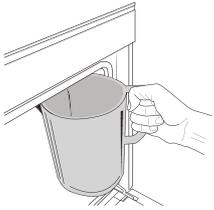
Nachdem die Funktion "Abpumpen" ausgewählt wurde oder dies vom Display angezeigt wird, die Funktion starten und die angegebenen Maßnahmen befolgen: Die Tür öffnen und eine große Kanne unter die Abpumpdüse rechts unter dem Bedienfeld positionieren. Nachdem
