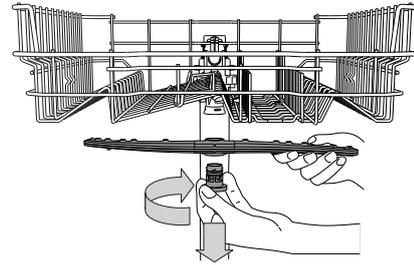
Zur Abnahme des oberen Sprüharms drehen Sie den Kunststoffring im Uhrzeigersinn. Der obere Sprüharm ist mit jener Seite nach oben wieder einzusetzen, die die meisten Löcher aufweist.
