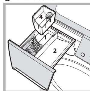
Questa funzione è utile per eliminare le macchie più resistenti. Inserire la vaschetta aggiuntiva 4, in dotazione, nello scomparto 1. Nel dosare la candeggina non superare il livello "max" indicato sul perno centrale (vedi figura). Per effettuare solo il candeggio versare la candeggina nella vaschetta aggiuntiva 4, impostare il programma "Risciacquo" e attivare l'opzione "Antimacchia" .
