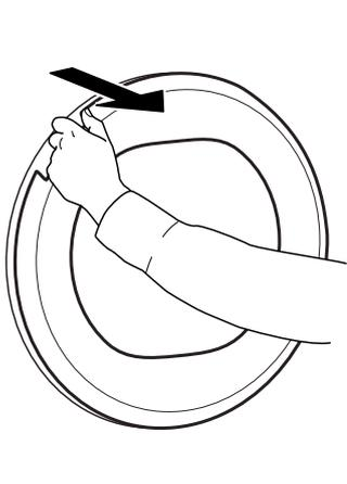
Zum Schließen der Tür, halten Sie den Griff und drücken Sie so, dass Sie die Verriegelung einrasten hören.
