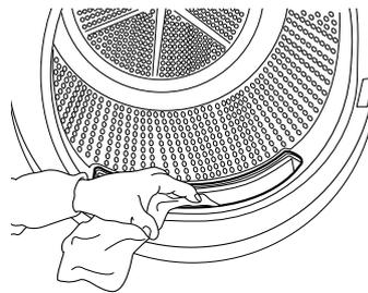
**5.** Schließen Sie den Filter und setzen Sie ihn in der richtigen Richtung ein, so dass er vollständig in das Filterfach integriert ist.
