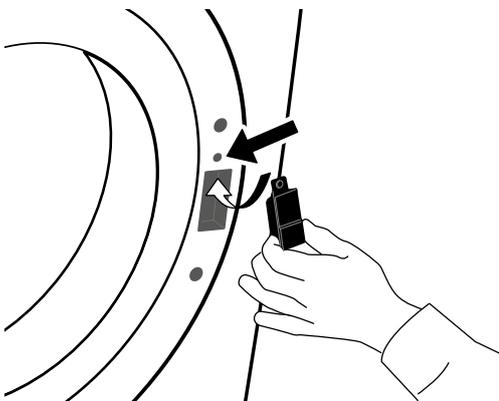
**19.** Die zwei Schrauben über und unter der Türverriegelung auf der rechten Seite der Türöffnung befestigen.
