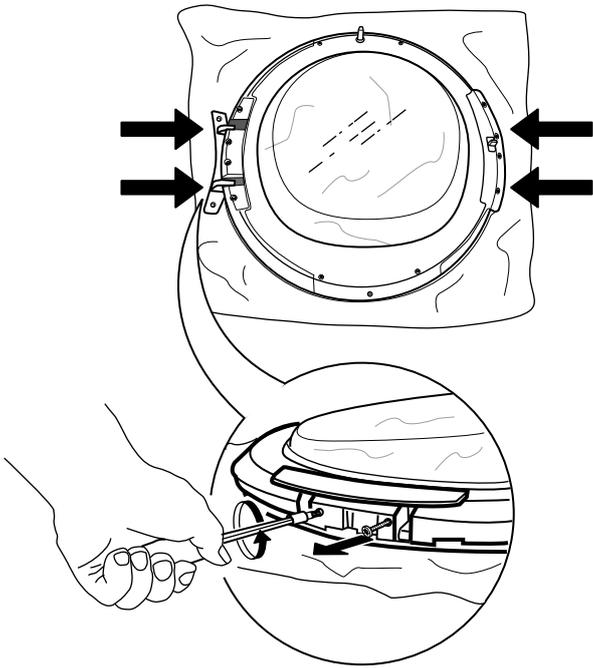
**10.** Die 4 inneren Schrauben auf jeder Türseite entfernen.
