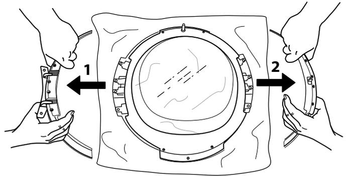
**12.** Die Seitenteile umdrehen und wieder einsetzen.
