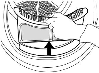
**2.** Drücken Sie die Taste, um das Türfilter zu öffnen.
