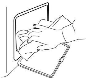
**8.** Bodensieb wieder einsetzen. Sicherstellen, dass er komplett in das Filterfach eingesetzt ist.
