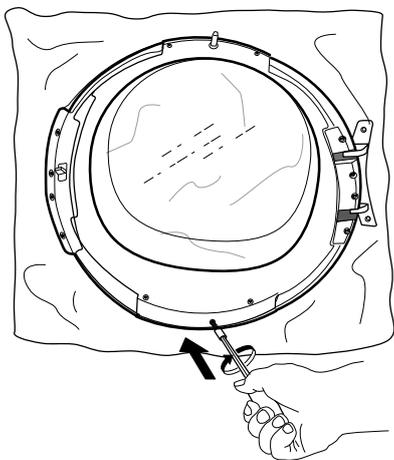
**18.** Die Türverriegelung auf der rechten Seite der Türöffnung anbringen. Vollständig in das Loch drücken und dann etwas nach unten schieben, bis der kleine Knopf der Türverriegelung einrastet.
