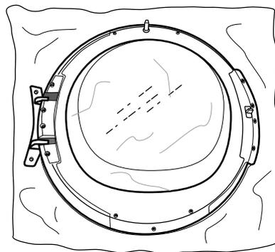
**5.** Die untere Schraube abschrauben, um den Abdeckrahmen an der Vorderseite der Tür zu lösen.
