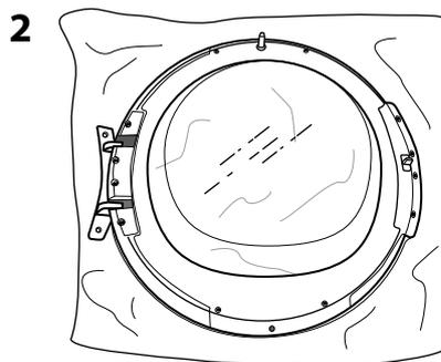
**9.** Die zwei seitlichen Schrauben entfernen. Dies auf beiden Seiten der Tür durchführen.
