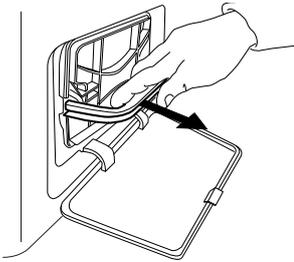
**3.** Entfernen Sie den Schaumstoff aus dem Bodensieb, um es zu reinigen.
