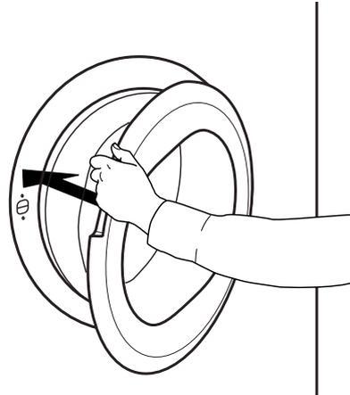
Wenn Sie die Tür öffnen und somit ein laufendes Programm unterbrechen, wird das Programm zurückgesetzt, wenn die Trocknertür innerhalb von einer Minute nicht wieder geschlossen wird.
