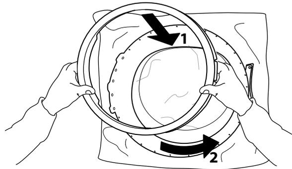
**17.** Drehen Sie die Tür erneut und legen Sie sie umgedreht hin. Die untere Schraube wieder befestigen.
