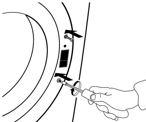
**20.** Die Tür auf der linken Seite der Türöffnung durch Eindrehen der beiden Schrauben befestigen.
