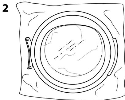
**7.** Vorsichtig den Türrahmen im Uhrzeigersinn drehen und entfernen.
