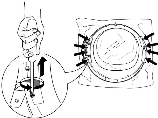
**11.** Die Seitenteile auf jeder Türseite entfernen.
