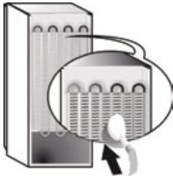
Kako biste osigurali stalni i ispravan protok vode odleđivanja, redovito čistite unutrašnjost ispusta na stražnjem dijelu hladnjaka u blizini ladice za voće i povrće pomoću isporučenog alata.
