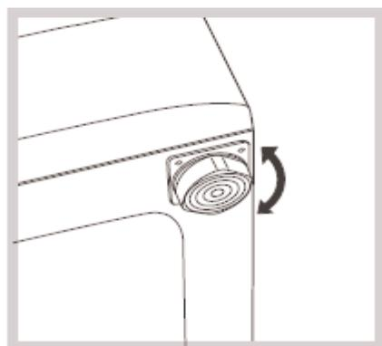
O nivelare precisă conferă stabilitate mașinii și evita vibrații, zgomote sau deplasări pe durata funcționării. În cazul mochetelor sau a unui covor, reglați piciorușele astfel încât să mențineți sub mașina de spălat un spațiu suficient pentru ventilare.
