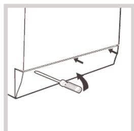
3. scoateți panoul de acoperire din partea din față a mașinii de spălat folosind o șurubelită (a se vedea figura).
