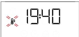
Veillez noter : Lors de la cuisson, vous pouvez changer la fonction en tournant le *bouton de sélection* ou ajuster la température en tournant le *bouton du thermostat*. La fonction ne démarre pas tant que le *bouton du thermostat* est sur **0**.
