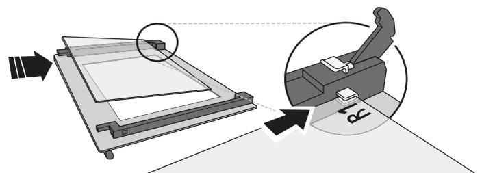
**4.** Remplacez le bord supérieur : un déclic indique le positionnement correct. Assurez-vous que le joint est bien placé avant de remplacer la porte.
