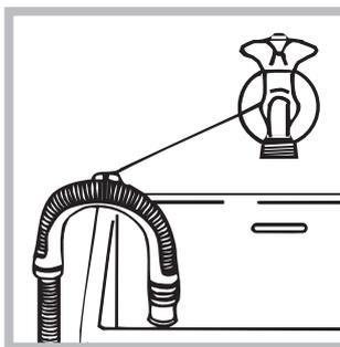
em alternativa, coloque na beira de um lavabo ou de uma banheira, prendendo na torneira a guia fornecida (veja a figura). A ponta solta do tubo de descarga não deve permanecer emergida na água.
