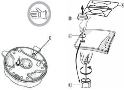
Avant d'installer la table de cuisson, n'oubliez pas de coller l'étiquette fournie avec les injecteurs contenant les informations correspondant au gaz utilisé.
