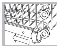
Abra os trincos das guias do cesto à direita e à esquerda e retire o cesto; disponha-o no alto ou em baixo, faça-o deslizar ao longo das guias até entrarem também as rodinhas anteriores e feche novamente os trincos (*veja a figura*).
