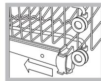
Ouvrir les butées des glissières du panier à droite et à gauche et sortir le panier. Positionner le panier en position haute ou basse, le faire glisser le long des glissières jusqu'à ce que les roues avant entrent elles aussi et refermer les butées
