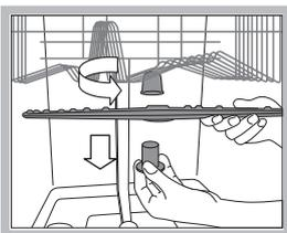
Zur Abnahme des oberen Sprüharmes drehen Sie den Kunststoffring gegen den Uhrzeigersinn ab. Der obere Sprüharm ist mit nach oben gerichteten Löchern wieder einzusetzen.
