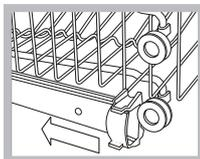
Öffnen Sie den rechten und linken Arretierstift der Korbführungen und ziehen Sie den Korb heraus; schieben Sie ihn in Hoch- oder Niedrigstellung ein; lassen Sie ihn über die Führungen nach hinten gleiten und schieben Sie hierbei auch die Vorderräder ein; schließen Sie die Arretierstifte (*siehe Abbildung*).
