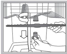
Para desmontar o aspersor superior deve-se desapertar girando o aro de plástico na direcção anti-horária. O braço aspersor superior deve ser remontado com os furos para cima.
