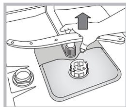
Der untere Sprüharm wird nach oben abgezogen.
