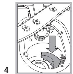
Na het reinigen van de filters dient u de filtergroep weer op zijn plaats te zetten. Dit is fundamenteel voor een goede werking van de afwasautomaat.
