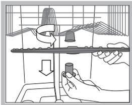
Para desmontar el rociador superior, es necesario desenroscar el casquillo de plástico girando en sentido antihorario. El rociador superior se vuelve a montar con los orificios dirigidos hacia arriba.
