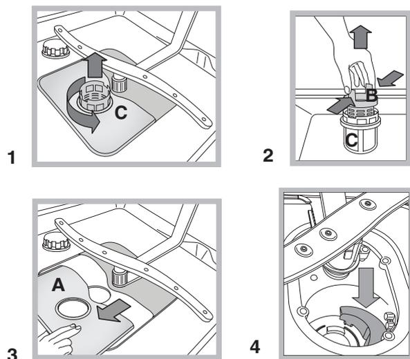
Après avoir nettoyé les filtres, remettre soigneusement le groupe filtrant à sa place, cette opération est fondamentale pour un bon fonctionnement du lave-vaisselle.
