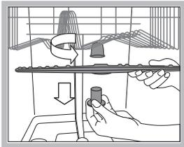
Om de bovenste sproeiarm uit elkaar te halen dient u de plastic dop linksom los te schroeven. De bovenste sproeiarm moet worden gemonteerd met de gaten naar boven gericht.
