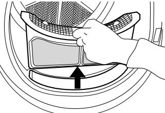
Pritisnite dugme da biste otvorili filter na vratima. Uklonite nakupljene ostatke tkanine. Zatvorite filter i ponovo ga ubacite u pravom smeru, tako da potpuno ulegne u komoru filtera.
