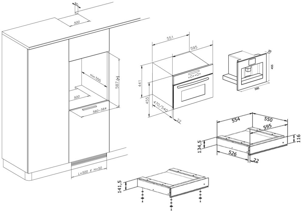
(\*) In caso di altezza dell'incasso del mobile di 595, il cassetto deve essere installato con i 4 piedini e le rispettive rondelle da 1mm nella parte inferiore, dati in dotazione nell'imballo.
