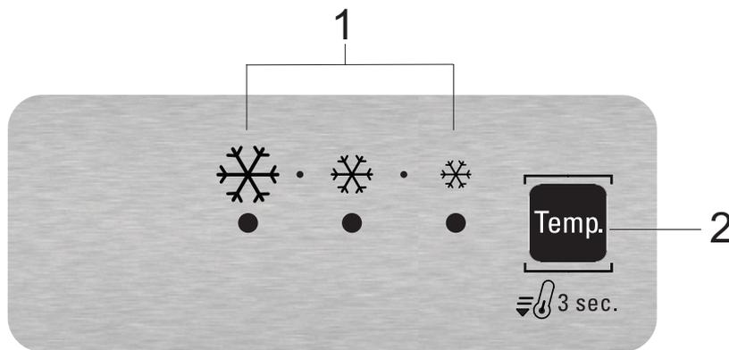
1. Anzeige-LEDs (zur Anzeige der aktuellen Temperatureinstellung oder der Schnellkühlfunktion)
