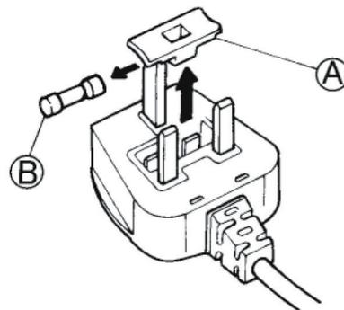
1. Entfernen Sie Sicherungsabdeckung (A) und Sicherung (B).
