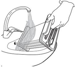
نظف مقصورة مرشح المجفف بقطعة قماش مبللة أو باستخدام المكنسة الكهربائية بعناية.
