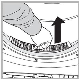
Bei Beendigung des Trockenvorgangs das Flusensieb immer unter fließendem Wasser spülen oder es mit dem Staubsauger reinigen. Falls das Flusensieb verstopft, wird der Luftstrom im Trockner stark beeinträchtigt: die Trockenzeiten verlängern sich und es wird mehr Energie verbraucht. Außerdem kann der Wäschetrockner beschädigt werden. Das Flusensieb befindet sich vor der Dichtung des Trockners (siehe
